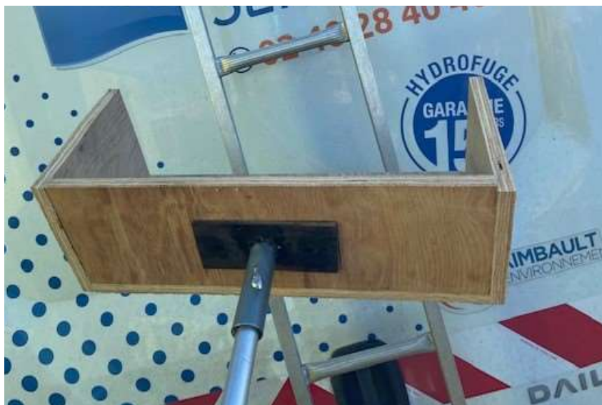
Caisson à 4 faces permettant de travailler autour des nids situés sous les toitures
