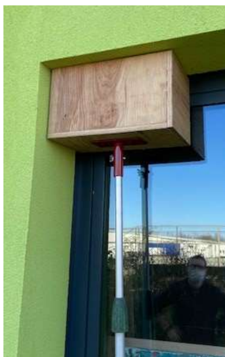
Caisson à 3 faces permettant de travailler autour des nids situés dans les angles
